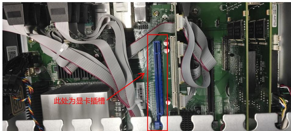
备注：显卡的金手指不能有脏污，显卡要紧靠插槽。
